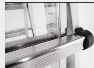
Pioli zigrinati (25x25 mm) con paracolpi alle estremità. Montanti in alluminio (51x22 mm).
