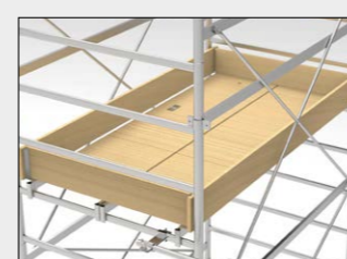
Piano di lavoro (1,10x1,90 m) in due pezzi, con botola, provvisto di fermapièdi anticaduta oggetti.
